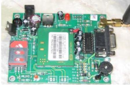
Fig 5. SIMCOM 300 GSM modem
