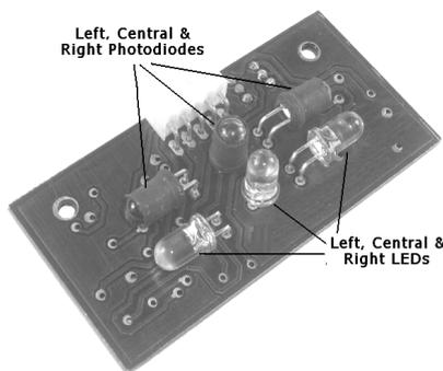
Fig. 4 LED Sensor Module
