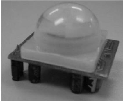
Fig. 5 PIR Sensor Module
