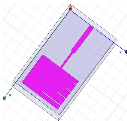
Fig.7 Edge fed rectangular patch antenna
