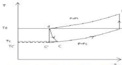
Fig. 5) T-S DIAGRAM OF VORTEX TUBE CYCLE
