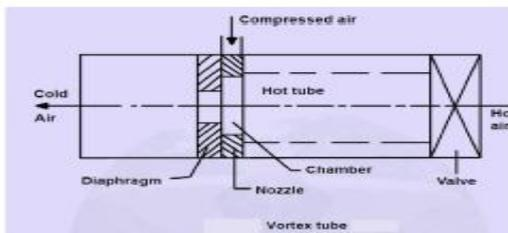
Fig. 4) SECTIONAL VIEW OF VORTEX TUBE
