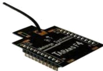
**Fig. 5. ZigBee Module**
