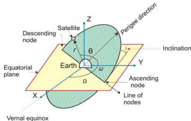
Fig. 4. Space orbital parameters
