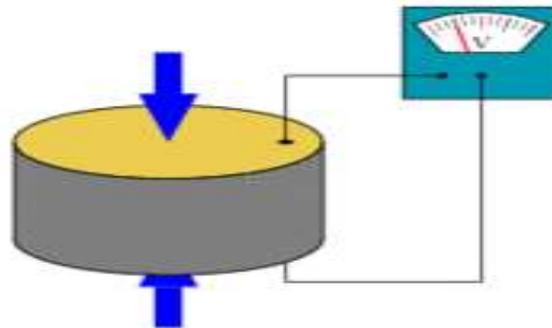
Fig (3). Piezoelectric Sensor
