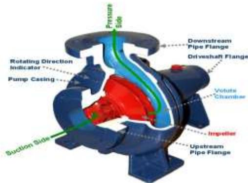
**Figure 10: Centrifugal Pump**
