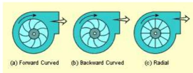
Figure 2: Centrifugal fan blades
